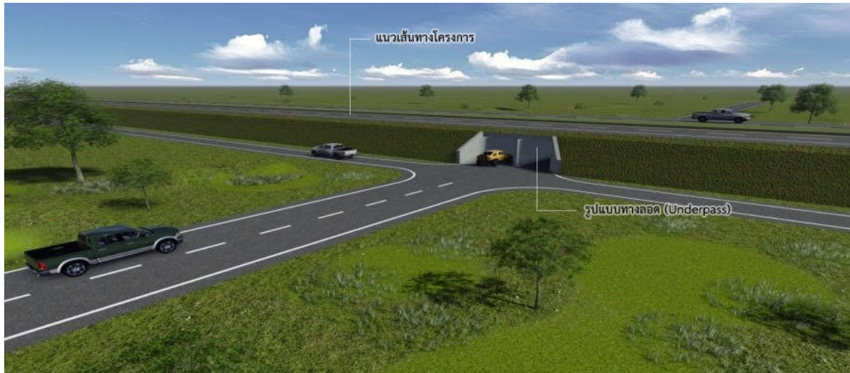
รูปที่ 2.1.1-9 รูปแบบทางลอด (Underpass) โครงการทางหลวงพิเศษระหว่างเมือง สายบางใหญ่-กาญจนบุรี ที่เสนอไว้ในรายงานการประเมินผลกระทบสิ่งแวดล้อม
