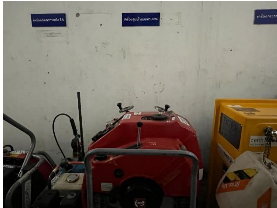
รูปที่ 39 เครื่องสูบน้ำดับเพลิงชนิดหามหาม
