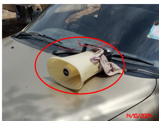
รูปที่ 11 เครื่องส่งสัญญาณเตือนการระเบิด
