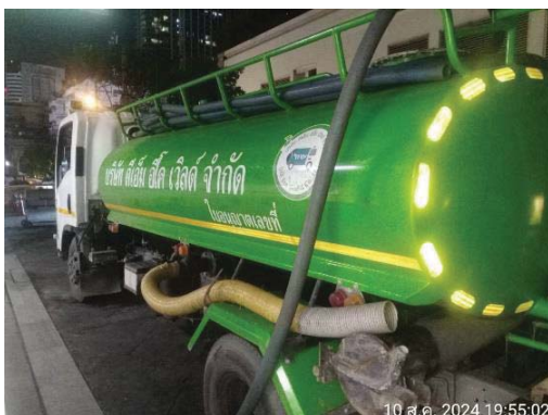
รถสูบล้างก่อนจากระบบบำบัดน้ำเสีย
