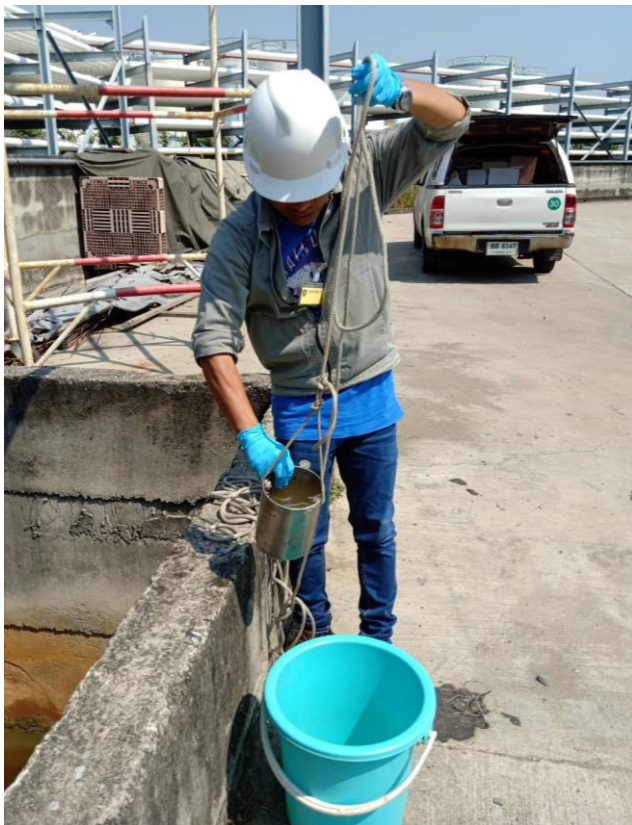
ภาพที่ 3-11 อุปกรณ์และวิธีการเก็บตัวอย่างน้ำทิ้ง
