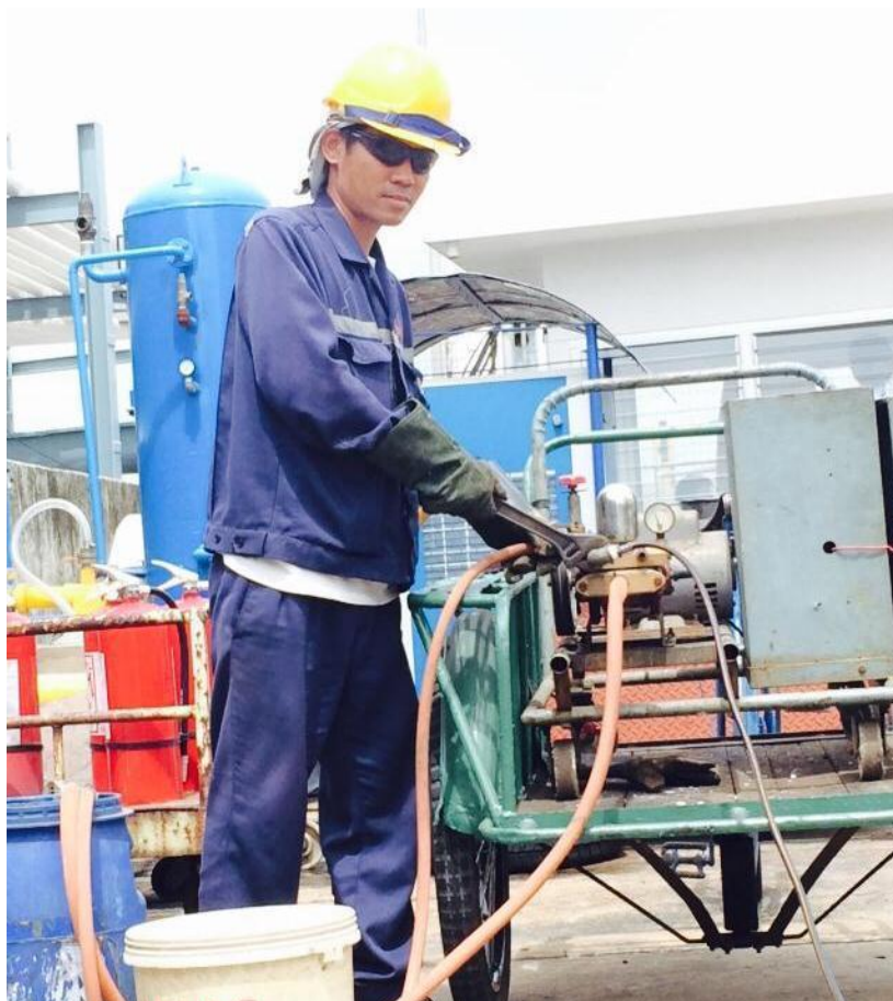
ภาพแสดงการตรวจสอบ FLEXIBLE HOSE ที่ใช้ในการขนถ่ายสินค้าจากเรือ (ต่อ)
