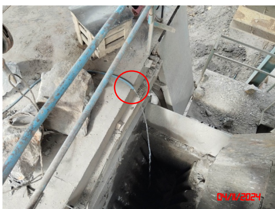
ระบบสปริงน้ำบริเวณแหล่งกำเนิดฝุ่นละออง
