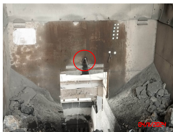
ระบบสปริงน้ำบริเวณแหล่งกำเนิดฝุ่นละออง
