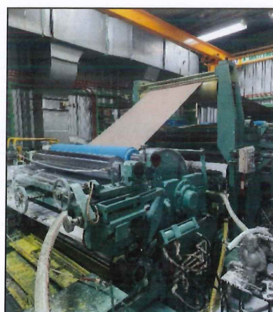
ภาพที่ 2.2-7 กระบวนการเคลือบสีลงแผ่นเหล็ก
