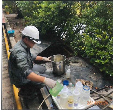
การเก็บตัวอย่างคุณภาพน้ำบริเวณบ่อกักน้ำเสียสุดท้ายก่อนระบายออกนอกโครงการ
