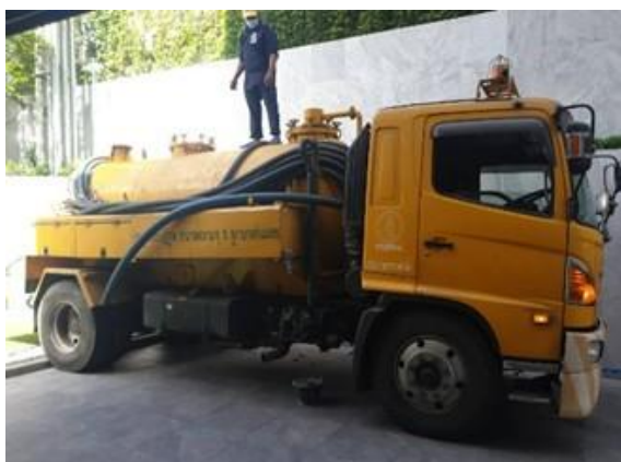
รูปที่ 2-59 การสูบล้างปลวกและตะกอน
