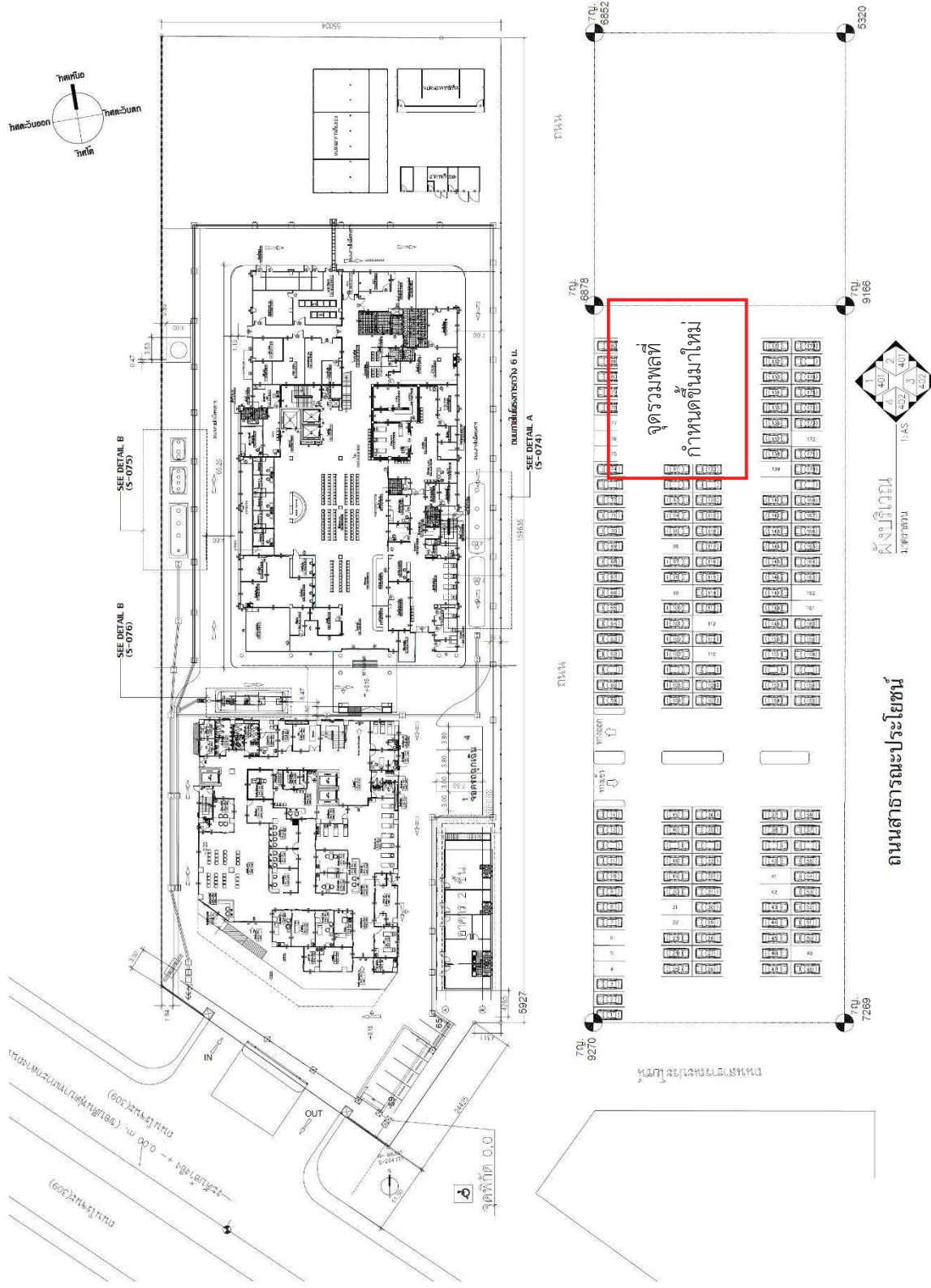
ภาพที่ 1.3.10 -1 ตำแหน่งที่รับน้ำดับเพลิงนอกอาคาร บ้านเดหนีไฟ จุดรวมพล เส้นทางอพยพจากบ้านเดหนีไฟไปยังจุดรวมพล และจุดจอดรถดับเพลิงบริเวณที่รับน้ำดับเพลิง
