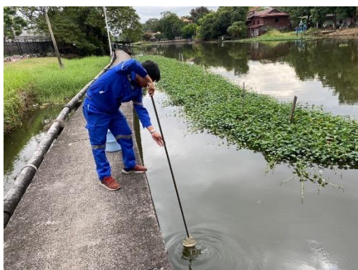
ภาพที่ 3.2.1-1 การเก็บตัวอย่างคุณภาพน้ำผิวดิน
