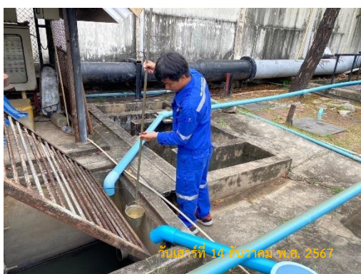
ภาพที่ 2-7 การเก็บตัวอย่างคุณภาพน้ำผิวดิน
