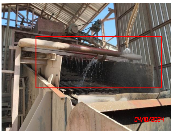
ระบบสเปรย์น้ำป้องกันฝุ่นละออง
