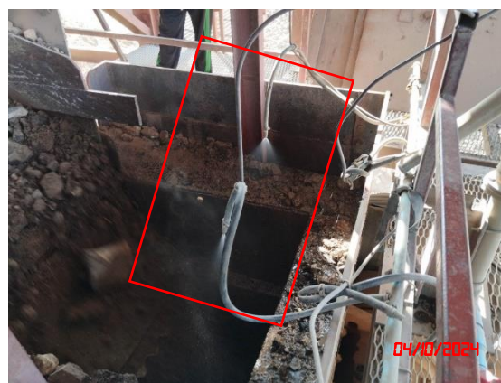
ระบบสเปรย์น้ำป้องกันฝุ่นละออง
