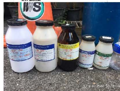
การเก็บตัวอย่างน้ำจุดน้ำเสียเข้าระบบบำบัดน้ำเสีย
