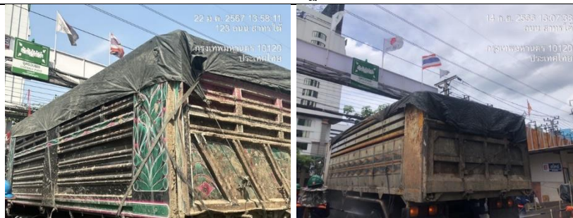
รูปที่ ๗7.7 คลุมผ้าใบรถขนส่งเศษคอนกรีตและดิน
