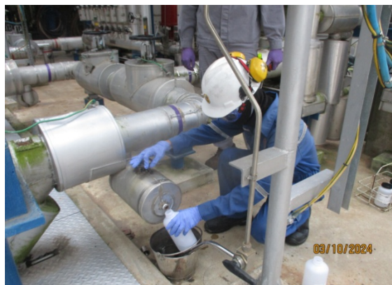
น้ำที่หมุนเวียนในระบบดักจับไอระเหยฟีนอลด้วยน้ำ ในระบบ Phenol Scrubber Stack D-1903
