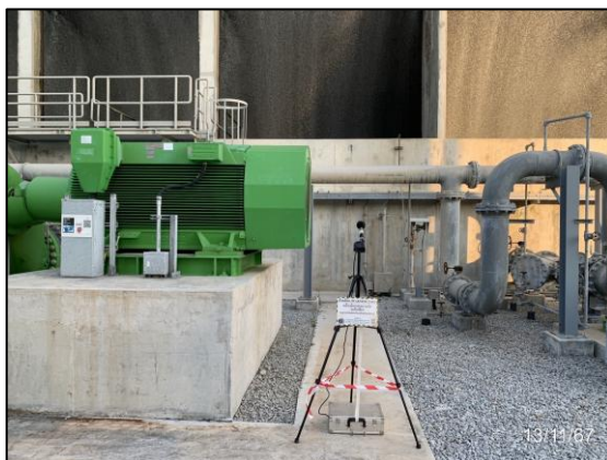
รูปที่ 3-13 การตรวจวัดระดับเสียงในพื้นที่ทำงาน บริเวณ หอหล่อเย็น
