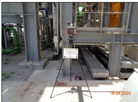
รูปที่ 3-17 การตรวจวัดระดับความร้อนในพื้นที่ทำงาน บริเวณ เครื่องกำเนิดไฟฟ้ากังหันไอน้ำ
