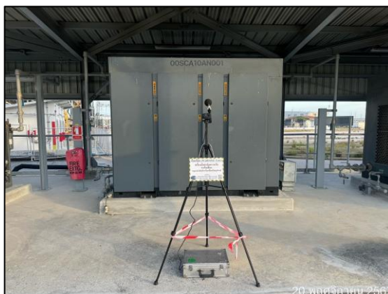
รูปที่ 3-12 การตรวจวัดระดับเสียงในพื้นที่ทำงาน บริเวณ เครื่องอัดอากาศ
