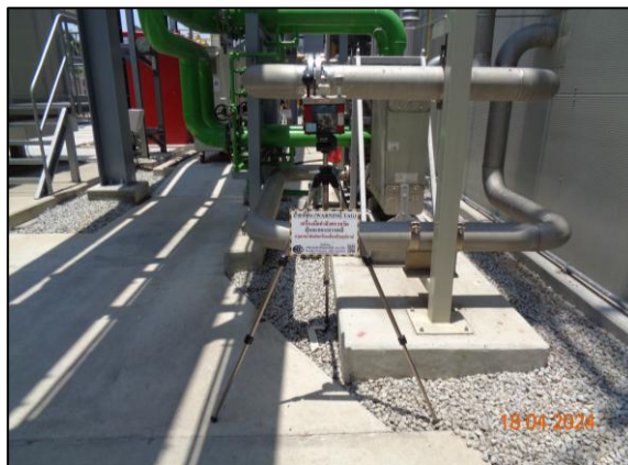
รูปที่ 3-16 การตรวจวัดระดับความร้อนในพื้นที่ทำงาน บริเวณ เครื่องกำเนิดไฟฟ้ากังหันก๊าซ
