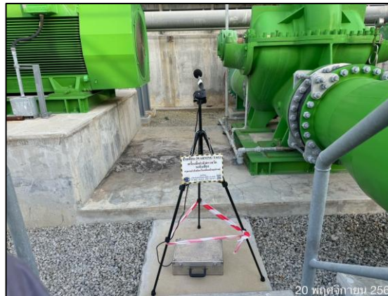
รูปที่ 3-13 การตรวจวัดระดับเสียงในพื้นที่ทำงาน บริเวณ หอหล่อเย็น
