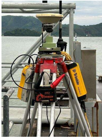
รูปที่ 4 การใช้ GPS ตั้งเป็นสถานีอ้างอิงค่าพิกัด (BASE)
