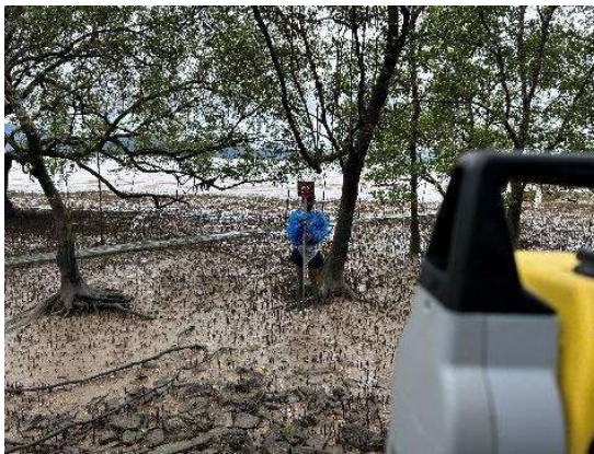
รูปที่ 4 การใช้ GPS ตั้งเป็นสถานีอ้างอิงค่าพิกัด (BASE)
