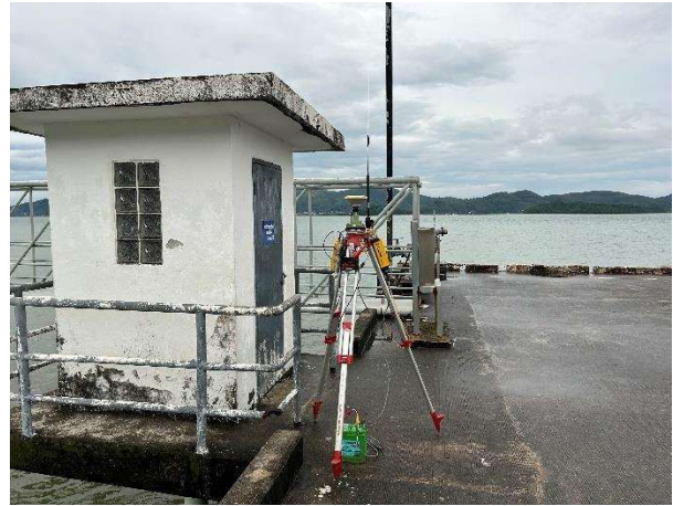
รูปที่ 4 การใช้ GPS ตั้งเป็นสถานีอ้างอิงค่าพิกัด (BASE)
