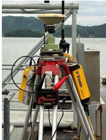
รูปที่ 3-4 GPS ตั้งเป็นสถานีอ้างอิงค่าพิกัด (BASE)
