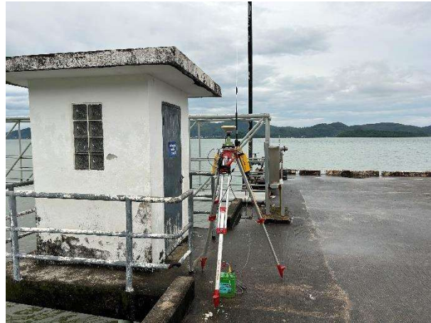
รูปที่ 3-4 GPS ตั้งเป็นสถานีอ้างอิงค่าพิกัด (BASE)
