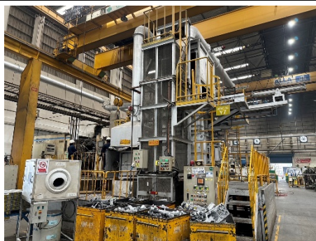
เตาหลอมแบบต่อเนื่อง Tower750 ในอาคาร DC4
