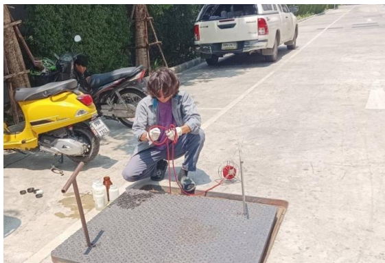
รูปที่ 3.2 จุดเก็บตัวอย่างคุณภาพน้ำทิ้ง บริเวณคุณภาพน้ำทิ้งก่อนระบายออกสู่ภายนอกโครงการ คือ บ่อตรวจคุณภาพน้ำพร้อมตะแกรงดักขยะ
