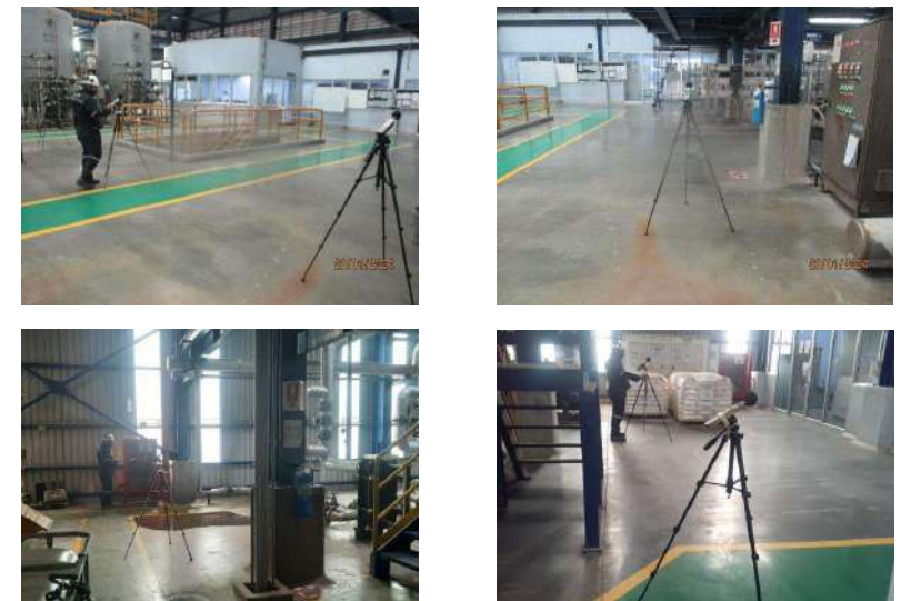
รูปที่ 5 การตรวจวัดระดับเสียง Noise Contour บริเวณพื้นที่ผลิตน้ำเชื่อม 2 ชั้น 2
