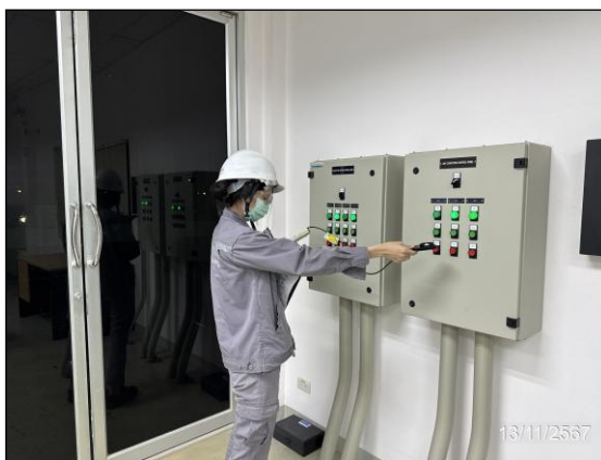
รูปที่ 3.15 การตรวจวัดความเข้มของแสงสว่างในพื้นที่ปฏิบัติงาน
