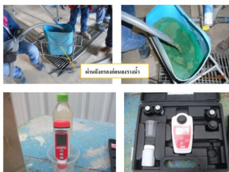
รูปที่ 6 การตรวจสอบคุณภาพน้ำทั้งจากการทดสอบการรับแรงดันด้วยน้ำ (Hydrostatic Testing)
