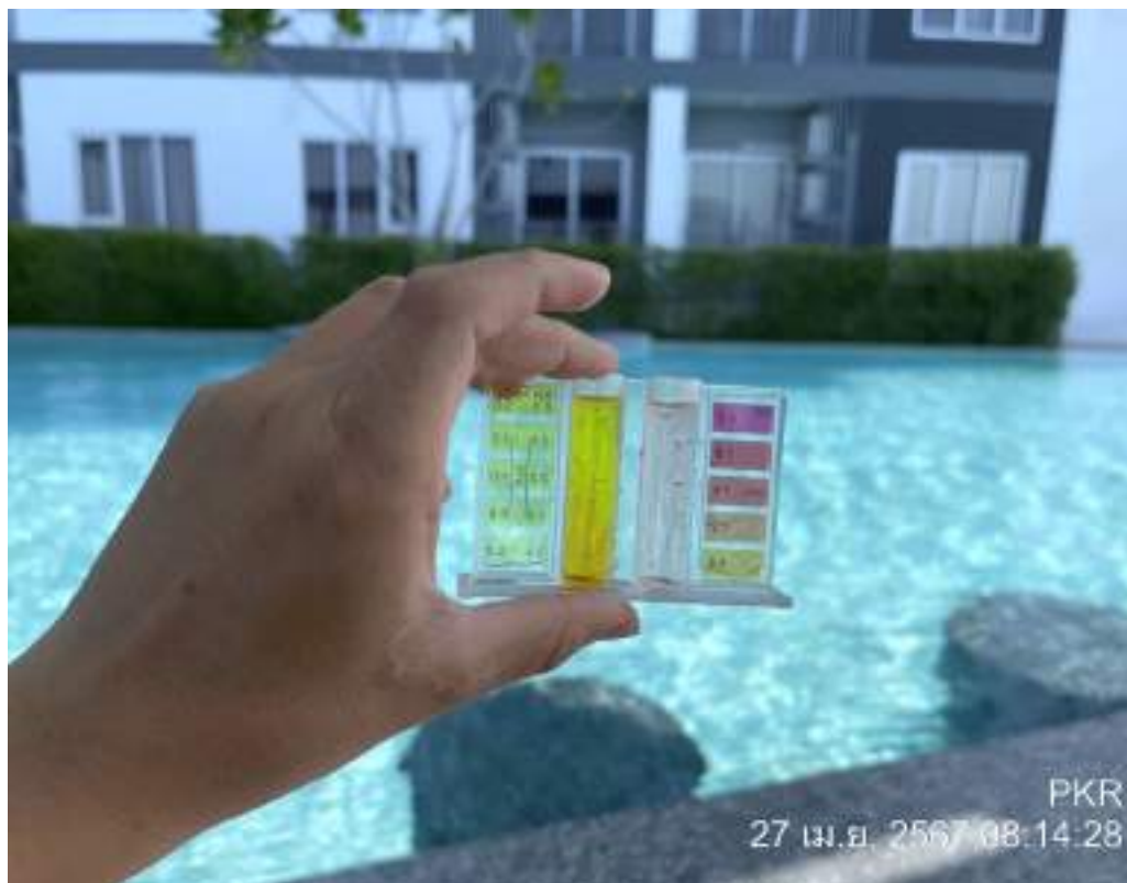
ภาพที่ 3-7(7.2) ช่างอาคารตรวจสอบคุณภาพน้ำสระว่ายน้ำ เช้า-เย็น ทุกวัน
