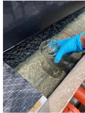
รูปที่ 3.5 ภาพแสดงการเก็บตัวอย่างน้ำจุดที่ 4 คุณภาพน้ำทิ้งที่เข้าและออกหอผึ่งเย็น บริเวณอ่างน้ำทิ้งจากหอผึ่งเย็น
