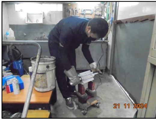
รูปที่ 19 การพนักงานสวมใส่อุปกรณ์ป้องกันความร้อน
