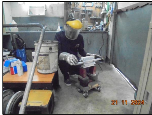
รูปที่ 19 การพนักงานสวมใส่อุปกรณ์ป้องกันความร้อน
