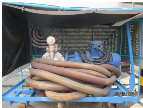
ปั๊มของเหลว (Diaphragm Pump)
