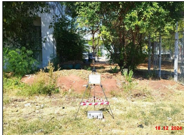
รูปที่ 3.11 การตรวจวัดระดับเสียงโดยทั่วไปและเสียงรบกวน บริเวณสำนักงานนิคมฯ ที เอฟ ดี 1 (N1)
