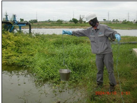
รูปที่ 3.7 การเก็บตัวอย่างคุณภาพน้ำทิ้ง บริเวณบ่อบำบัดน้ำทิ้ง
