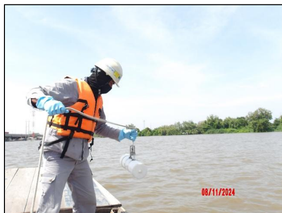
รูปที่ 3.6 การเก็บตัวอย่างคุณภาพน้ำผิวดิน บริเวณแม่น้ำบางปะกง บริเวณจุดระบายน้ำทิ้งของโครงการ (SW2)
