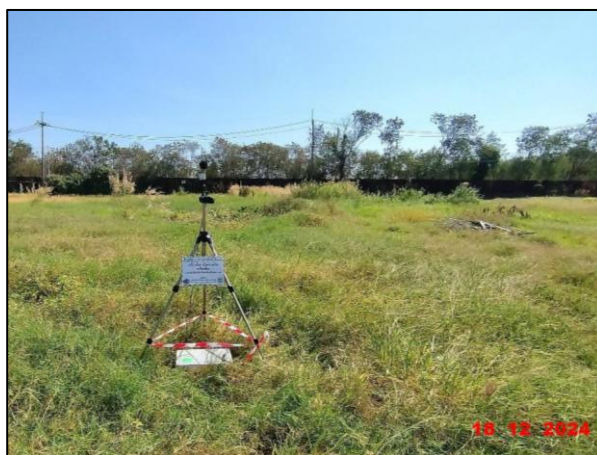
รูปที่ 3.15 การตรวจวัดระดับเสียงโดยทั่วไปและเสียงรบกวน บริเวณชุมชนหมู่ 3 บ้านบางควาย (N5)
