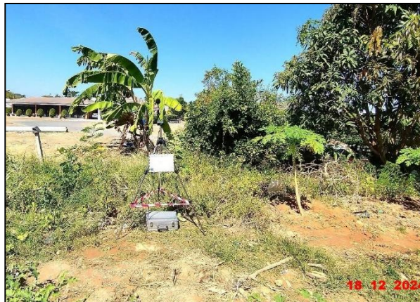
รูปที่ 3.26 การตรวจวัดระดับเสียงโดยทั่วไปและเสียงรบกวน บริเวณชุมชนหมู่ 3 บ้านคลองบ้านหมู่ (N4)
