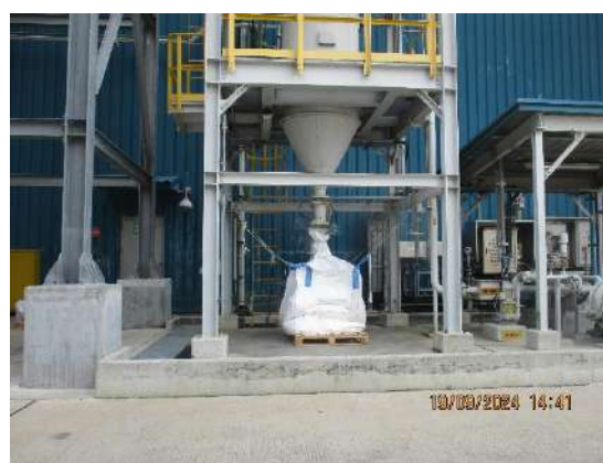
รูปที่ 2-32 ระบบรวบรวมฝุ่นจากบริเวณที่มีการฟุ้งกระจาย ของสารเติมแต่ง
