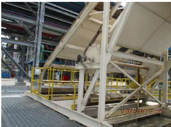
รูปที่ 2-7 ปอดักโฟลิมเมอร์และเครื่องตักตะกอน
