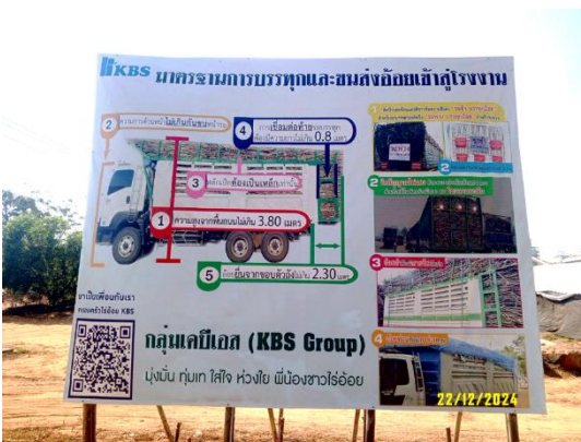
รูปที่ 46 ข้อกำหนดของรถบรรทุกอ้อย
