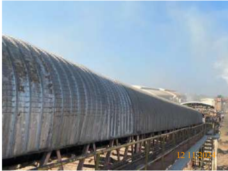
ภาพที่ 2.2-7 ระบบสายพานลำเลียงแบบปิด
