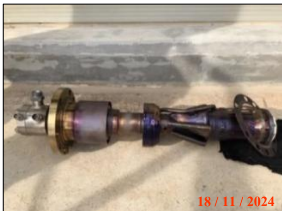
รูปที่ 2.2 อุปกรณ์ Burner ในระบบหัวฉีดเผาไหม้แบบ Dry Low NO x (ต่อ)
