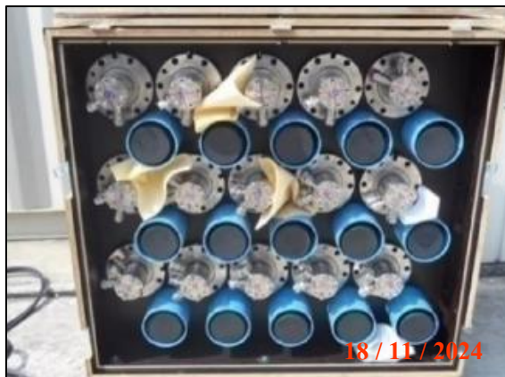
รูปที่ 2.2 อุปกรณ์ Burner ในระบบหัวฉีดเผาไหม้แบบ Dry Low NO x (ต่อ)
