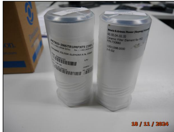
รูปที่ 2.3 อะไหล่สำหรับอุปกรณ์ในระบบตรวจวัดคุณภาพอากาศแบบต่อเนื่อง (CEMs) (ต่อ)
