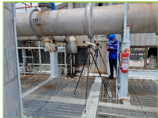
ภาพที่ 1 แสดงการตรวจวัดระดับเสียงเพื่อจัดทำแผนผังแสดงระดับเสียง (Noise Contour Map) (ต่อ)
