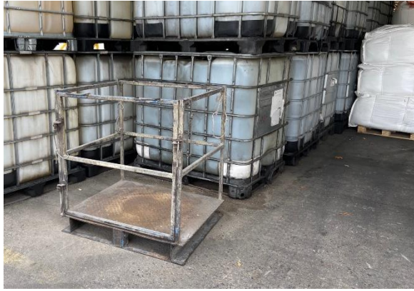
รูปถ่ายที่ 3.2-30 : โครงเหล็กกันถังเคมีขณะเคลื่อนย้าย
