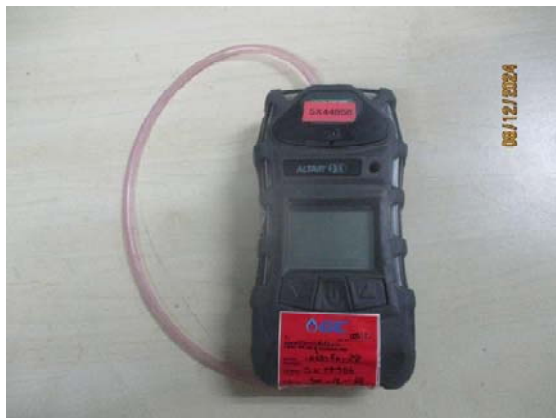
รูปที่ 3.1-1 (รูปที่ 57 Combustible Gas Detector)
