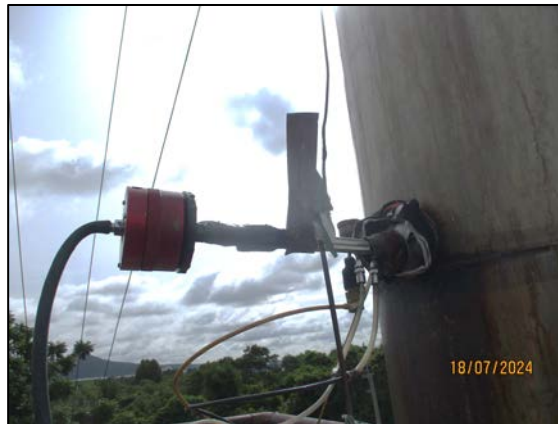
รูปที่ 3.1 การเก็บตัวอย่างคุณภาพอากาศปลายปล่องเตาเผาขยะ บริเวณ ปลายปล่องเตาเผาขยะ
