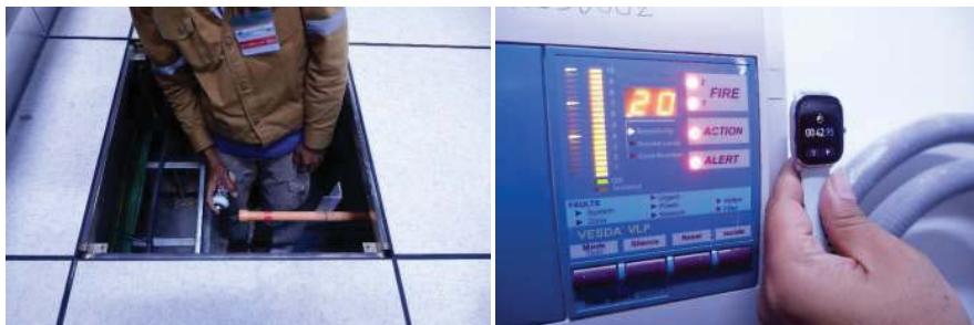
Test Alarm Pipe Line 1 ทดสอบได้เวลา 42.95 วินาที
