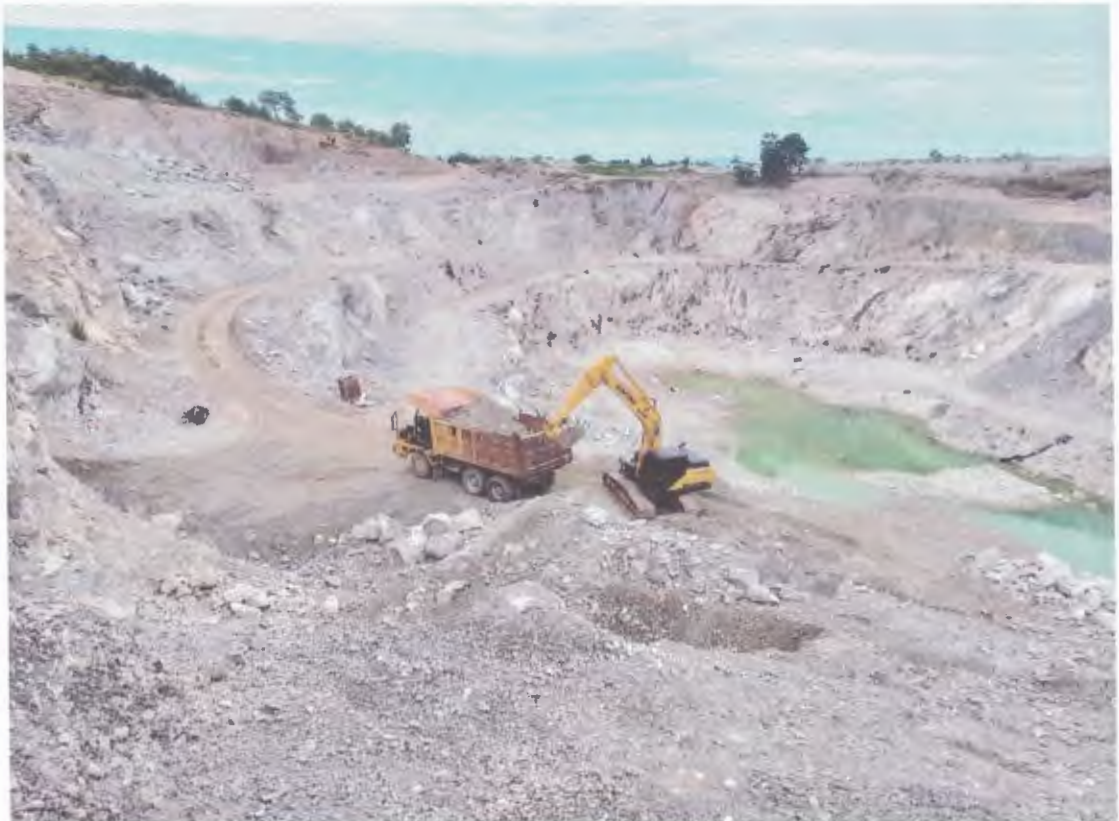
รูปที่ 9 แสดงการการทำเหมืองหาบในลักษณะเหมืองเปิด (Open pit)
