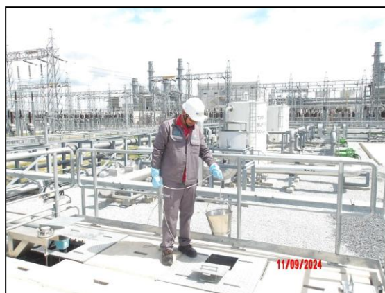
รูปที่ 3.9 การเก็บตัวอย่างคุณภาพน้ำทิ้ง บริเวณ W 3 : บ่อตรวจจลบน้ำทิ้งหอหล่อเย็น BPAT3 (CT Blow DOWN Sump BPAT3)
