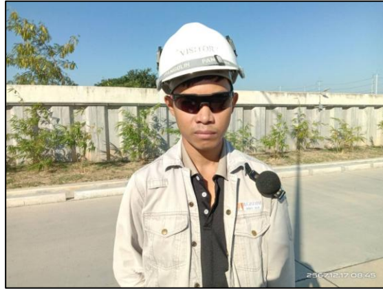
รูปที่ 3.17 การตรวจวัดระดับเสียงสะสมแบบติดที่ตัวบุคคล (Noise Dose) บริเวณ Maintenance (คุณระพีพัฒน์ แต่งใบ)
