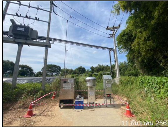
รูปที่ 3.6 การเก็บตัวอย่างคุณภาพอากาศในบรรยากาศ บริเวณ ชุมชนหลักฟ้า
