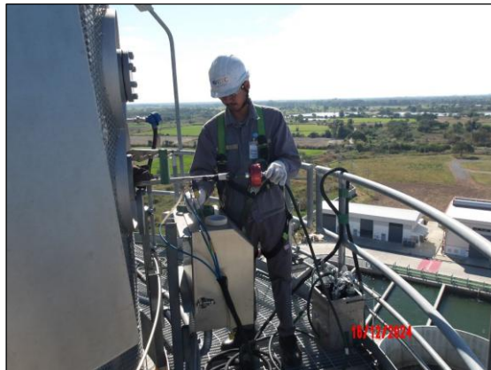
รูปที่ 3.2 การเก็บตัวอย่างคุณภาพอากาศในปล่องระบาย บริเวณ ปล่อง HRSG 32
