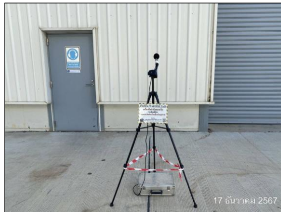
รูปที่ 3.13 การตรวจวัดระดับเสียงในพื้นที่ทำงาน บริเวณ Steam Turbine Generator
