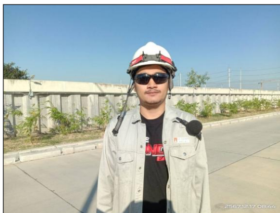
รูปที่ 3.16 การตรวจวัดระดับเสียงสะสมแบบติดที่ตัวบุคคล (Noise Dose)
