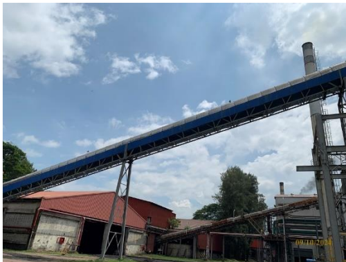
รูปที่ 5 สายพานลำเลียงเชื้อเพลิงแบบปิด
