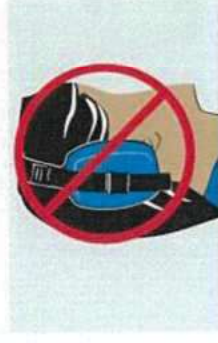
- ตำแหน่ง Ear Cups ที่ไม่ครอบคลุมส่วนใบหูทั้งหมด ภาพสามนี้ใส่ที่ไม่ถูกต้อง :
