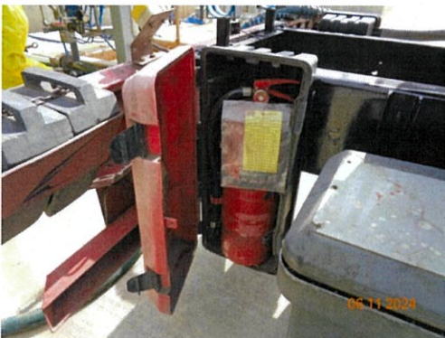
รูปที่ 3-20 อุปกรณ์ระงับเหตุฉุกเฉิน ประจำรถขนส่งสารเคมี
