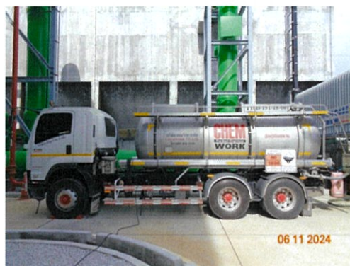
รูปที่ 3-30 อุปกรณ์รััดถังของรถขนส่งสารเคมี
