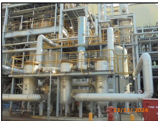
ภาพที่ 4 อุปกรณ์ดักฝุ่นแบบ Venturi Scrubber
