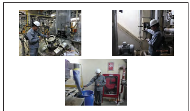
ภาพที่ 4 แสดงการตรวจวัดความเข้มของแสงสว่างในบริเวณการทำงาน (ช่วงเวลากลางคืน)
