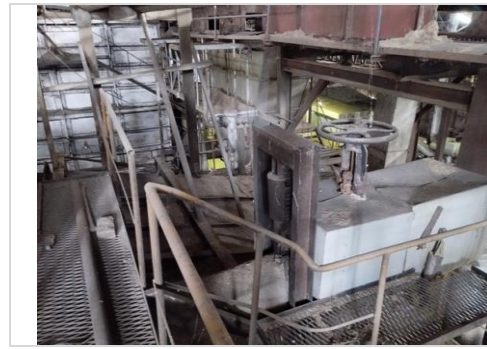
Control valve วาล์วควบคุมความดัน
