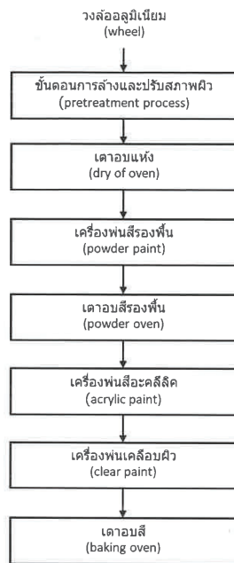
รูปที่ 1-2 ผังขั้นตอนส่วนการผลิตวงล้ออลูมิเนียมทำสีและกลึงเงา
