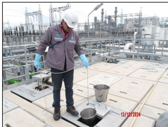
รูปที่ 3.10 การเก็บตัวอย่างคุณภาพน้ำทิ้ง บริเวณ W 3 : บ่อตรวจลอนน้ำทิ้งหอหล่อเย็น (CT Blow DOWN Sump BPAT2)
