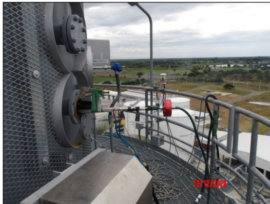
รูปที่ 3.2 การเก็บตัวอย่างคุณภาพอากาศในปล่องระบาย บริเวณ ปล่อง HRSG 22
