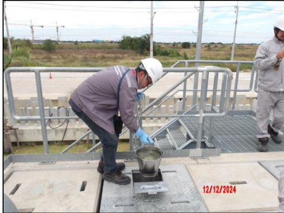
รูปที่ 3.11 การเก็บตัวอย่างคุณภาพน้ำทิ้ง บริเวณ W 4 : บ่อตรวจสอบน้ำเสีย (Waste Water Pit BPAT2)
