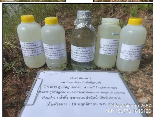
รูปที่ 3.4.2-12 การเก็บตัวอย่างน้ำทิ้งของระบบบำบัดน้ำเสียส่วนกลาง
