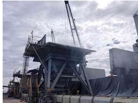
ภาพที่ 2-8 การฉีดพ่นน้ำบริเวณปาก Hopper
