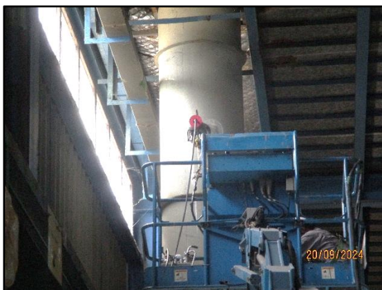
รูปที่ 3.3 การเก็บตัวอย่างคุณภาพอากาศจากแหล่งกำเนิดปล่องระบาย บริเวณ Stack เครื่อง PK01-02
