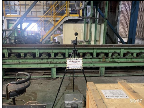
รูปที่ 3.19 การตรวจวัดระดับเสียงในพื้นที่เฉพาะ บริเวณ RM01 (MC#9)
