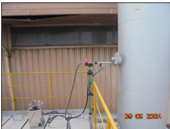
รูปที่ 3.10 การเก็บตัวอย่างคุณภาพอากาศเพื่อตรวจสอบประสิทธิภาพของระบบดักกรองฝุ่น
