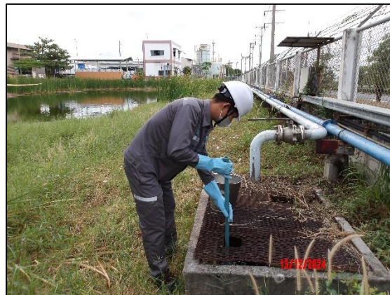
รูปที่ 3.12 การเก็บตัวอย่างคุณภาพน้ำทิ้ง บริเวณ หลังผ่านระบบบำบัด
