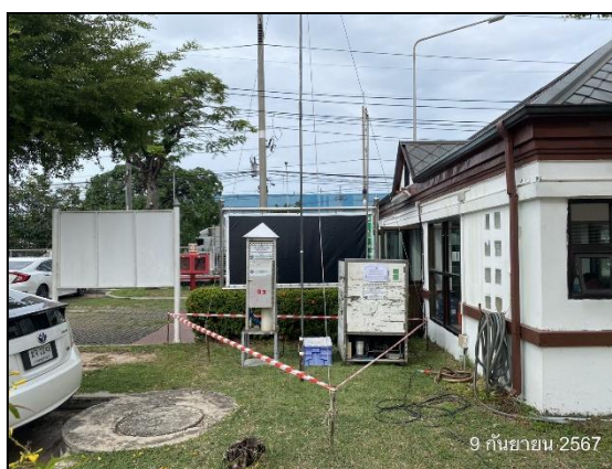
รูปที่ 3.7 การเก็บตัวอย่างคุณภาพอากาศในบรรยากาศท้ายลมมรสุม บริเวณใกล้ทางเข้าออกภายในโรงงานหลอมทองเหลือง
