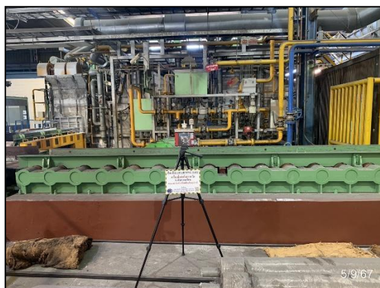
รูปที่ 3.24 การตรวจวัดระดับความร้อนในพื้นที่ทำงาน บริเวณ เตารีดขนาด (Hot Rolling)
