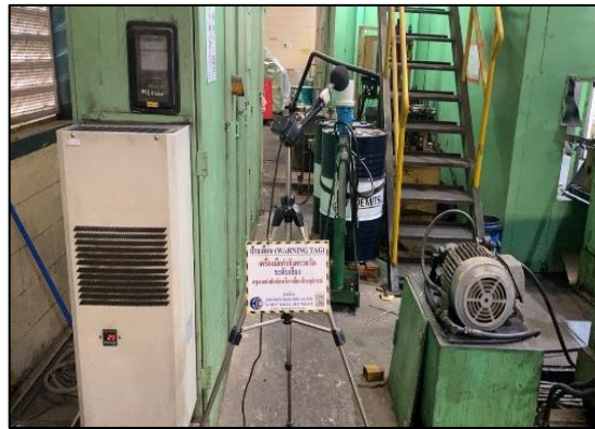
รูปที่ 3.20 การตรวจวัดระดับเสียงในพื้นที่เฉพาะ บริเวณ Blanking (BK)
