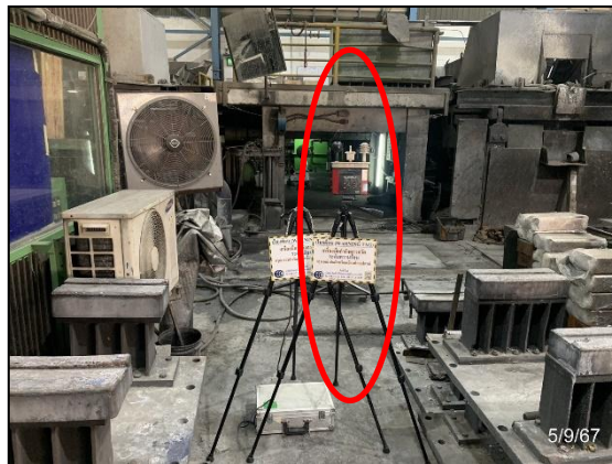
รูปที่ 3.23 การตรวจวัดระดับความร้อนในพื้นที่ทำงาน บริเวณ เตาหล่อ (Casting)
