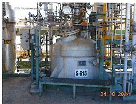
ภาพที่ 2-6 ถัง Hydrolyser
