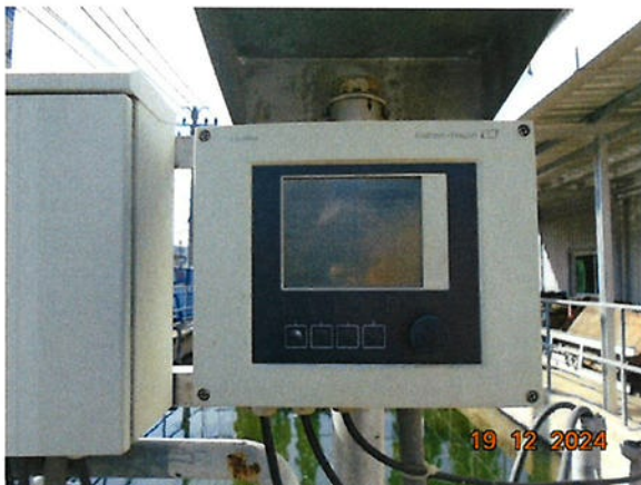
ภาพที่ 2.2-18 เครื่องวัดค่าความเป็นกรด-ด่าง และ เครื่องวัดค่าการนำไฟฟ้าแบบอัตโนมัติ
